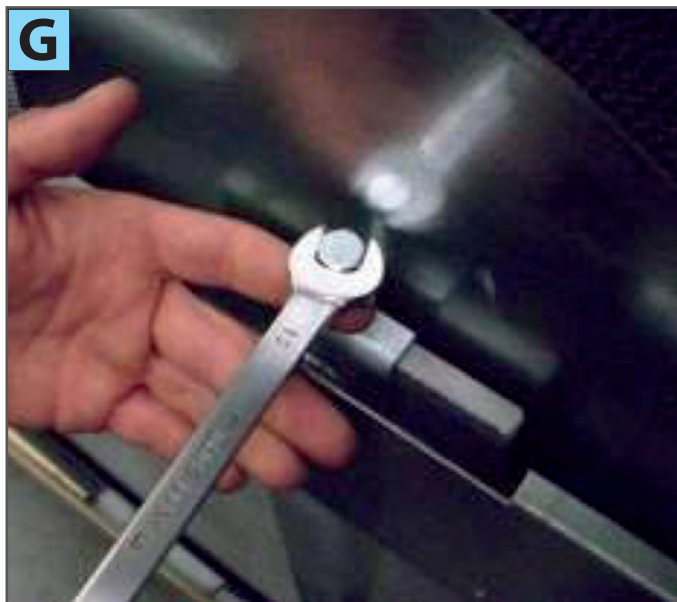
3) Upravte sbíhavost kola pomocí šroubu 2 (foto G)
