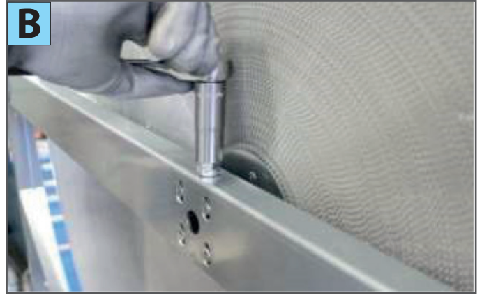
2) Stellen Sie die Einwärtsstellung des Rades mit Hilfe der vertikalen Schraube ein (Foto B)
