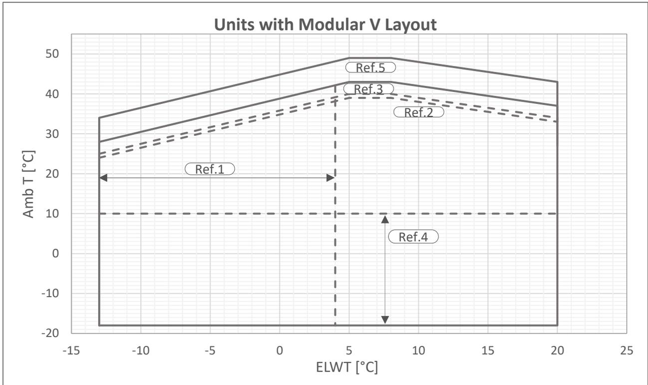
**Fig. 9 - Multi V-Limites de funcionamento Prata**
