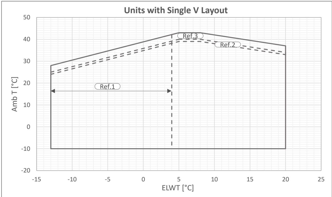
Fig. 11 - Single V-Limites de funcionamento Prata
