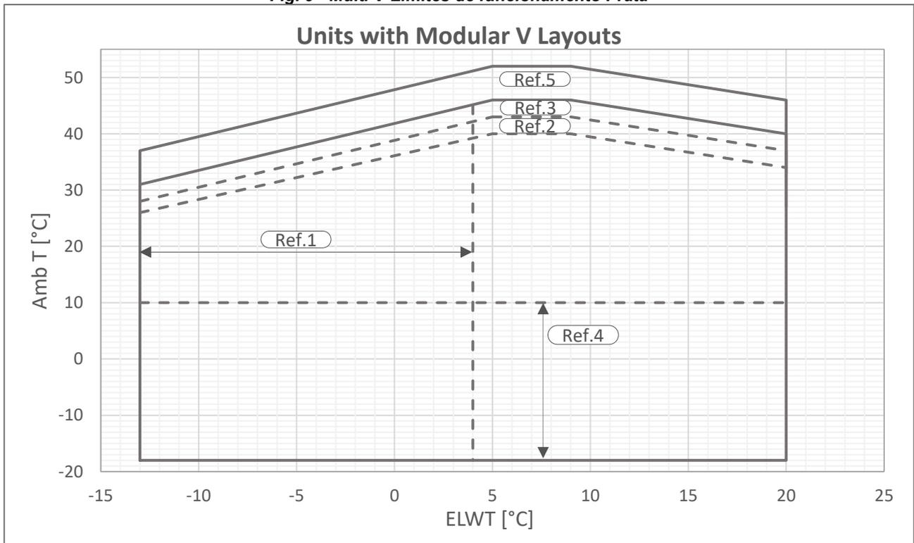
**Fig. 10 - Multi V-Limites de funcionamento Ouro**
