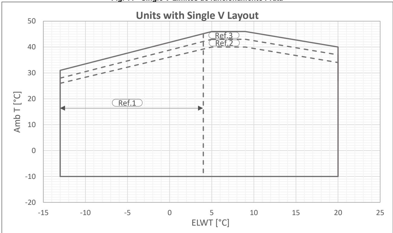
Fig. 12 - Single V-Limites de funcionamento Ouro
