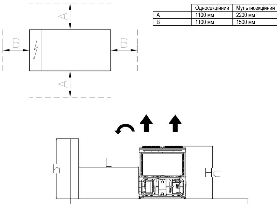
Якщо  $h < H_c \rightarrow L \geq 3,0$  м (мультисекційний) /  $L \geq 1,8$  м (односекційний). Якщо  $h > H_c$  або  $L$  менше рекомендованої відстані, слід звернутися до свого дистриб'ютора Daikin, щоб оцінити можливі варіанти розміщення.
