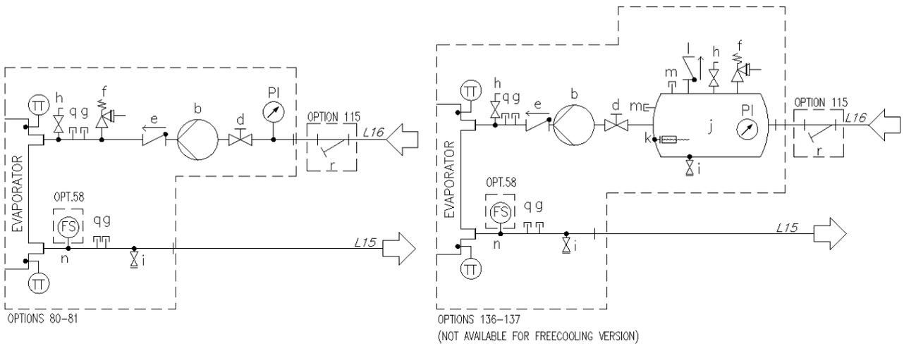
**Рис. 11. Гідравлічна схема односекційного агрегату (EWAТхх5В) зі з двоєним насосом (компл. 80-81/136-137) (макс. робочий тиск 6 бар)**
