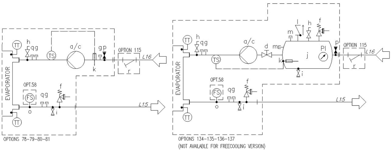
**Рис. 12. Гідравлічна схема мультисекційного агрегату (EWAТхх0В) (компл. 78-79-80-81/134-135-136-137) (макс. робочий тиск 6 бар)**
