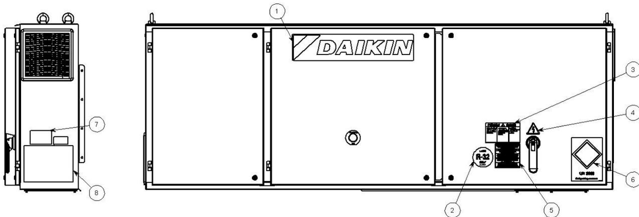
Рис. 16. Опис табличок, нанесених на електричний щит
