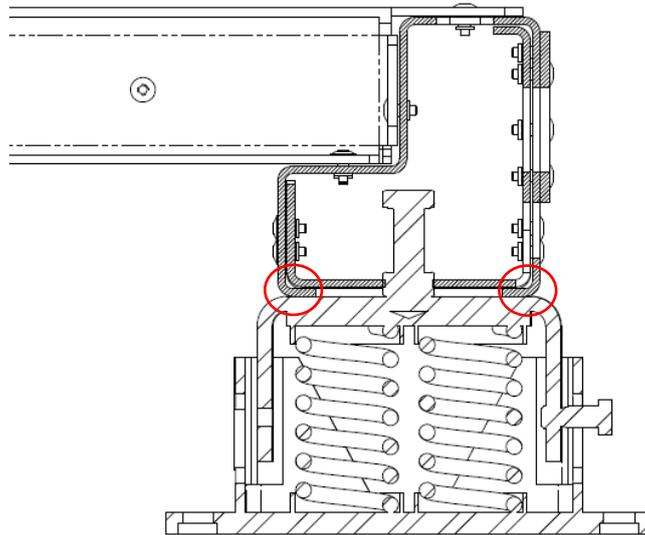
**Abb. 18- Vibrationsdämpfende-Elemente Montage (als Option geliefert)**
