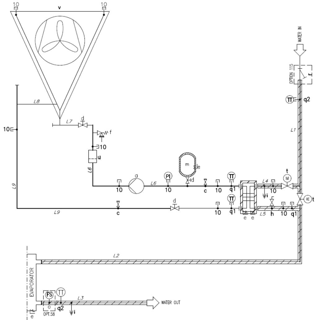
Abb. 21 – Geschlossene Schleife Hydronic Freie Kühlung P&ID (Opt. 231)
