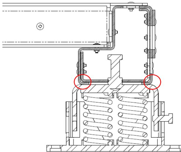
**Fig. 18 - Montagem de elementos anti-vibração (fornecidos como opção)**
