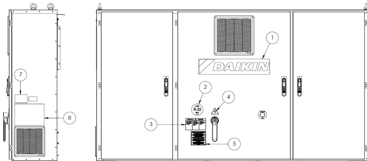
Fig. 23– Descrição das etiquetas aplicadas no painel elétrico (medio).
