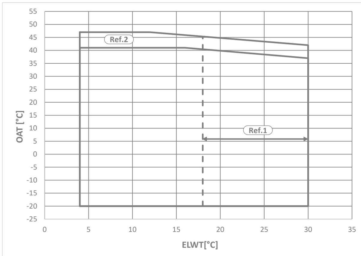
**Fig. 6– EWFT-B-C Limites de funcionamento Silver**
