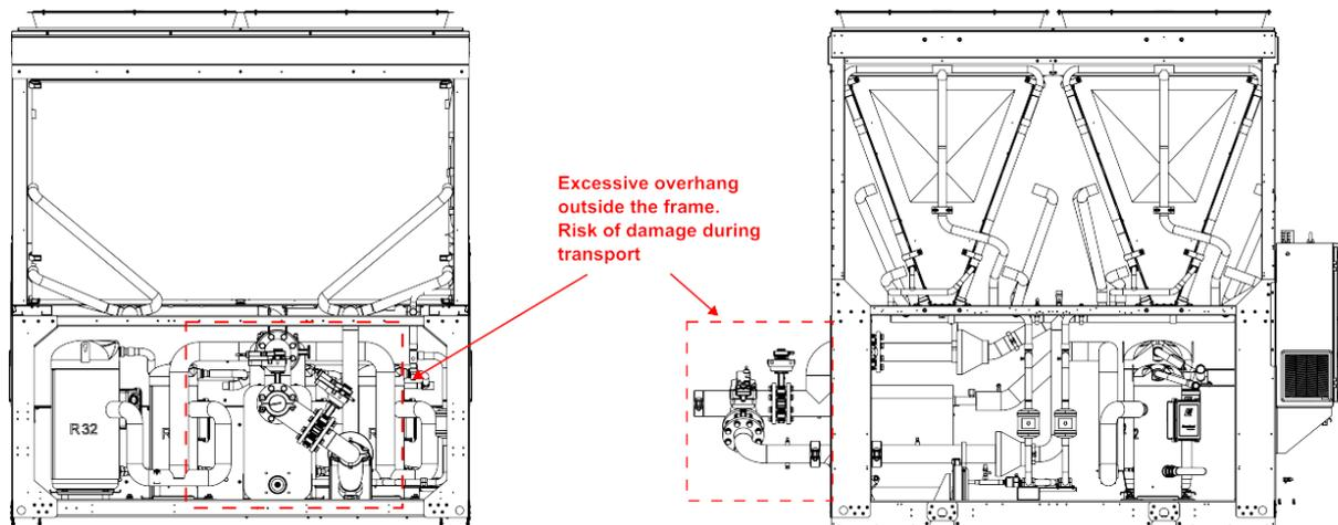
Fig. 16– Tubulação fora da pegada de unidades de refrigeração livre.
