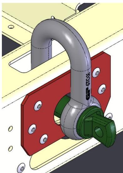
**Fig. 10 - Fixação das manilhas de elevação**
