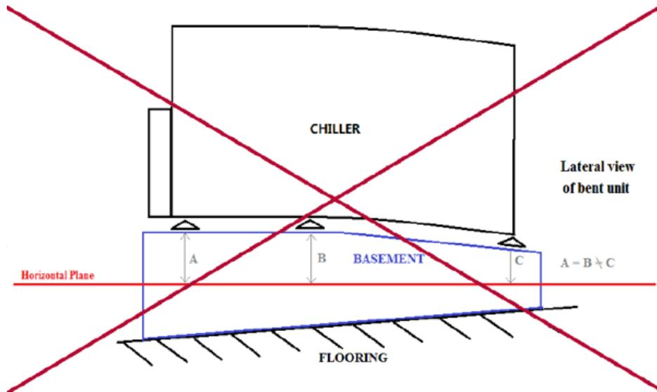
Fig. 13- Nivelamento da unidade
