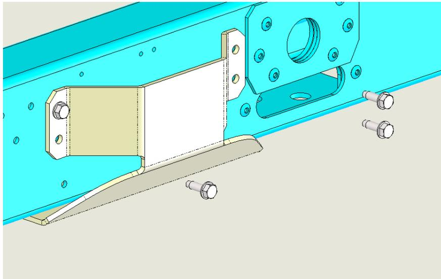
**Fig. 12 – Parafusos M8 para ligação placa-estrutura da unidade**
