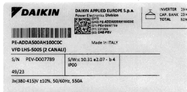
Kuva 31 – VFD LHS laitekilpi
