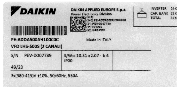
Obrázek 31– Identifikační štítek VFD LHS
