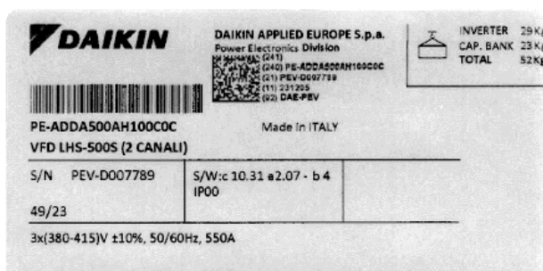
Rys. 31- Etykieta identyfikacyjna VFD LHS
