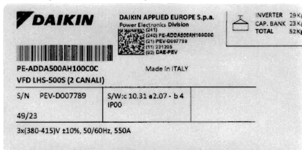
Fig. 31- Identifieringsetikett för VFD LHS
