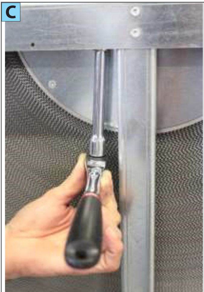
1) Desaperte os dois parafusos (foto C)
