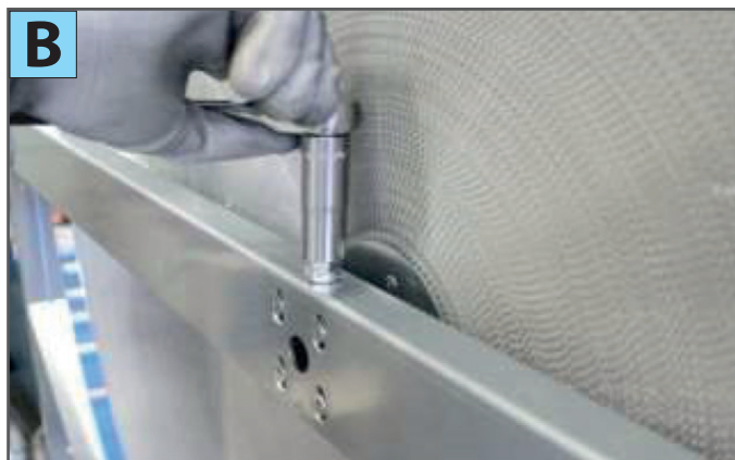
2) Ρυθμίστε τη σύγκλιση τροχού χρησιμοποιώντας το κάθετο μπουλόνι (φωτογραφία B)
