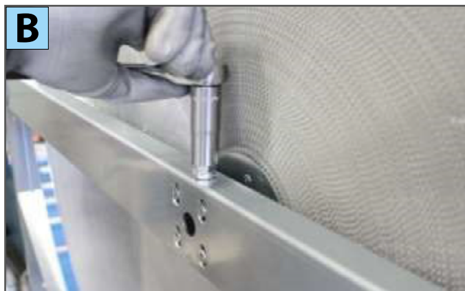
2) Podesite bočno poravnanje kotača pomoću okomitog vijka (fotografija B)
