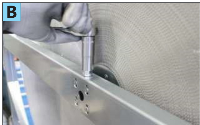
2) Seřídte konvergenci kola s použitím svislého svorníku (fotografie B)
