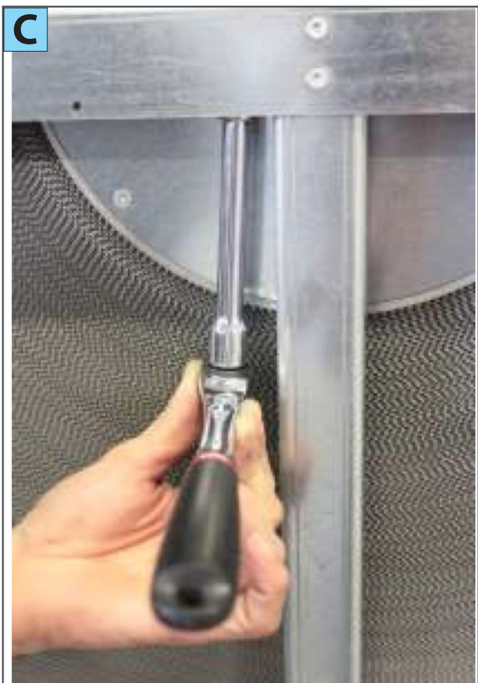
1) Desaperte os dois parafusos (foto C)
