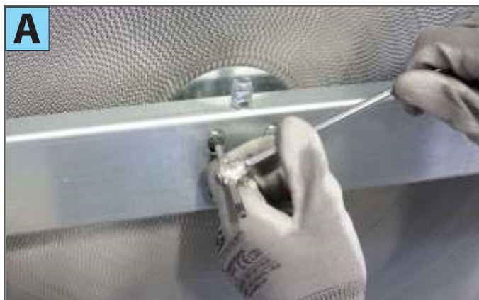
1) Desaperte os 4 parafusos (foto A)
