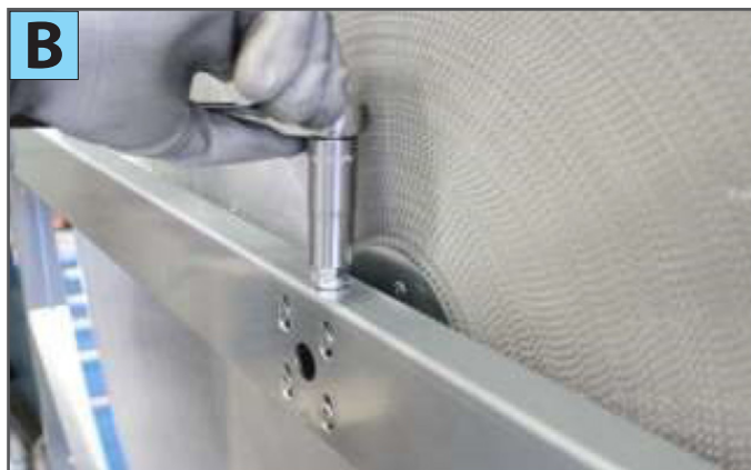
2) Regule a convergência da roda com um parafuso vertical (foto B)
