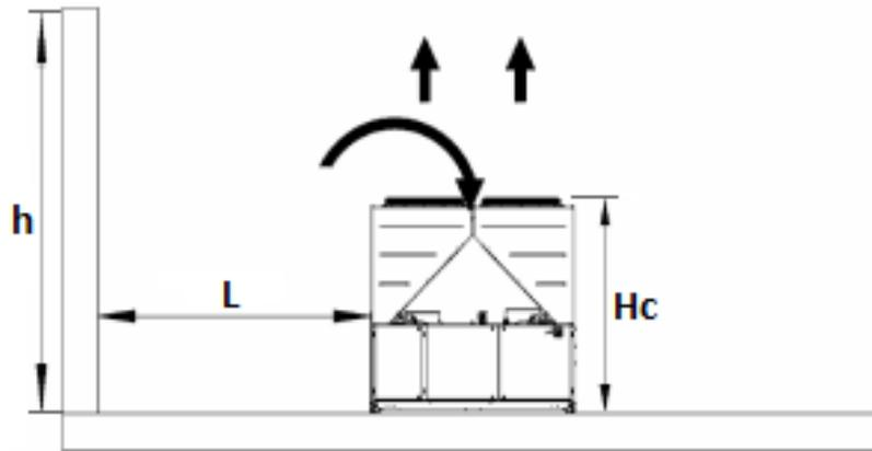
Ist  $h < H_c \rightarrow L \geq 3,0$  m (mehrere V) /  $L \geq 1,8$  m (parallele Rohrschlange); ist  $h > H_c$  oder L niedriger als empfohlen, wenden Sie sich an Ihren Daikin-Fachhändler, um die verschiedenen möglichen Anordnungen zu beurteilen.
