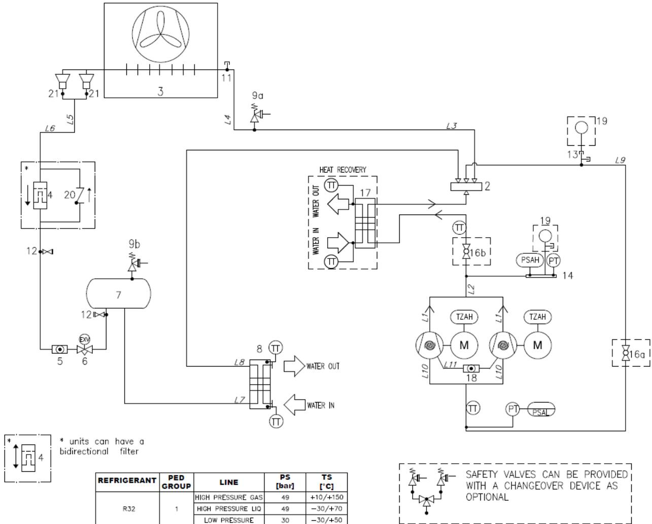
**Abb. 19 – Einzel-Kreislauf-Gerät EWYTx5B - Kältemittel-Leitungsschema (P&ID)**
