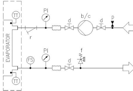
**Abb. 6 – Hydraulikschemata ohne eingebaute Pumpe(n) (max. Betriebsdruck 20 bar)**
