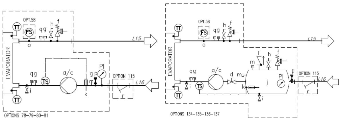
**Abb. 10 – Hydraulikschema für Einzel- / Doppelpumpengerät (Opt. 78-79-80-81/134-135-136-137)
