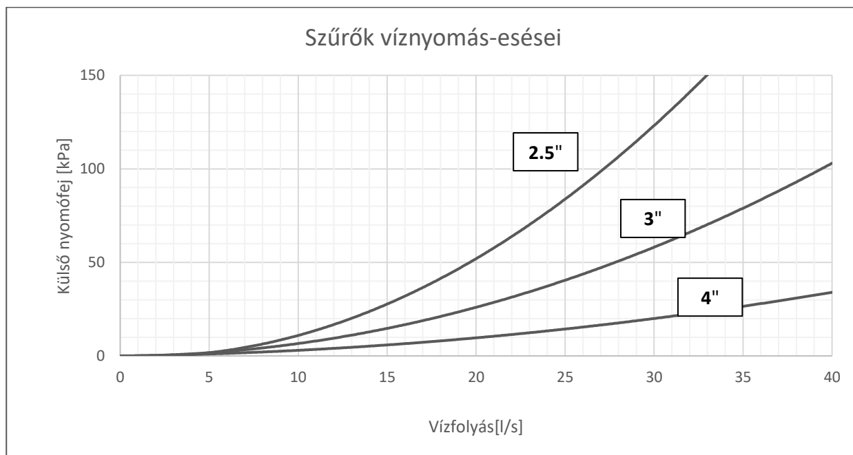
18. ábra – Vízsűrítő nyomásesései
