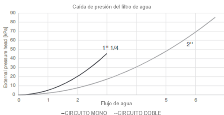
Figura 11 - Pérdidas de presión del filtro de agua
