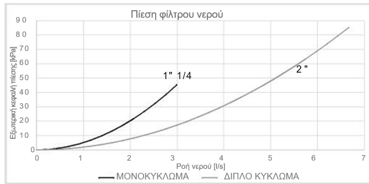
Εικόνα 11 - Πτώσεις πίεσης του φίλτρου νερού
