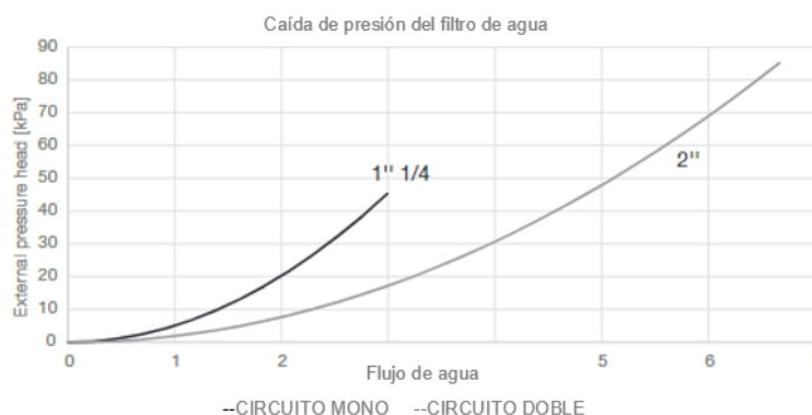
Figura 11 - Pérdidas de presión del filtro de agua
