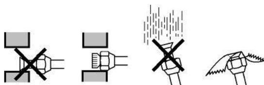
Vous devez utiliser des raccords évasés pour relier les conduites de liquide et de refoulement à la tuyauterie du condenseur séparé. Afin d'utiliser le bon diamètre de tuyau, se reporter à la section "Spécifications techniques"
