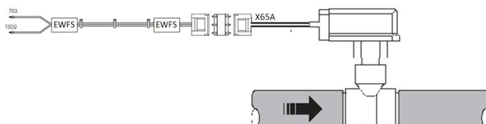
Une borne est prévue dans le coffret électrique pour permettre le branchement électrique du contacteur de débit.
