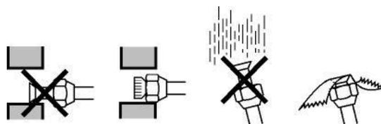
Le linee di scarico e del liquido devono essere collegate con gli attacchi della cartella alle tubature del condensatore con comando a distanza. Per l'utilizzo del diametro corretto del tubo, consultare "Specifiche tecniche"
