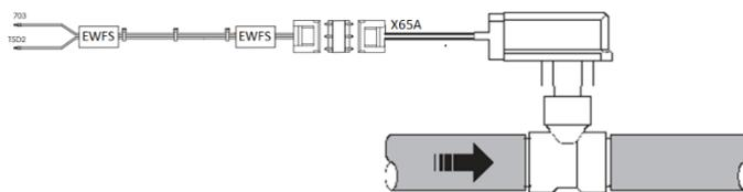
Nella morsetteria viene fornito un morsetto specifico per il collegamento elettrico del flussostato. Fare riferimento allo schema di collegamento:
