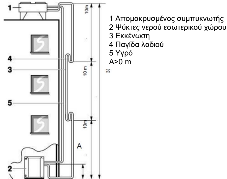
Εικόνα 20 – Σύνδεση του κυκλώματος ψυκτικού (1)
