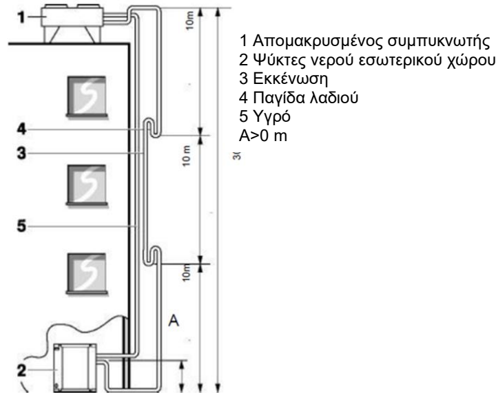
Εικόνα 20 – Σύνδεση του κυκλώματος ψυκτικού (1)
