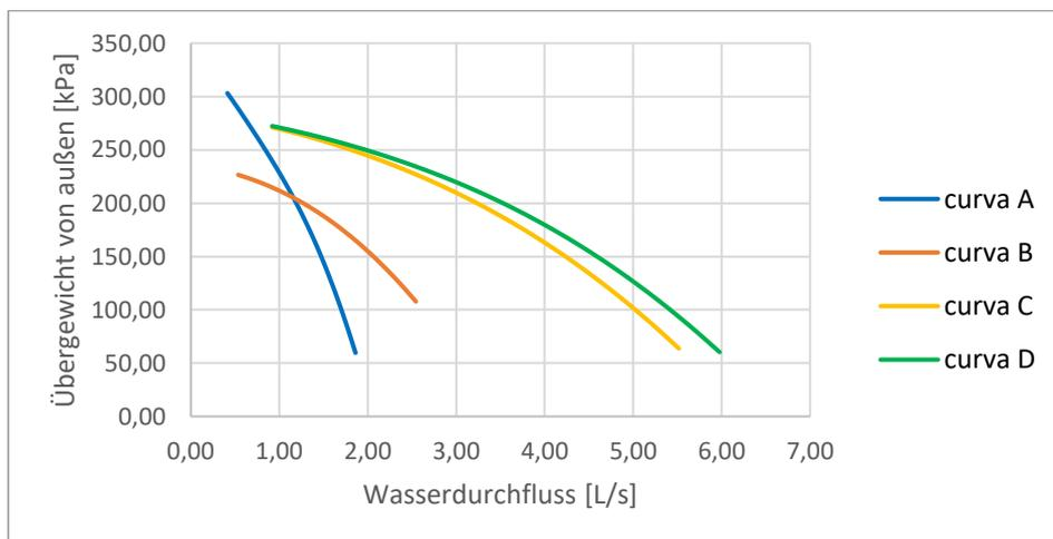
Abbildung 14 - Externe Druckhöhe einer Pumpe mit geringer Förderhöhe
