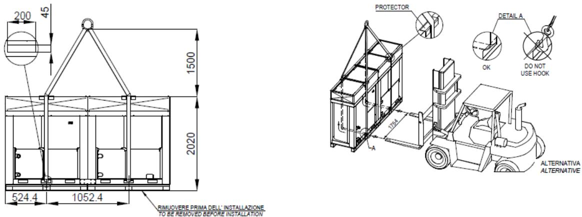
Abbildung 4 – Anheben der DUAL-Einheit
