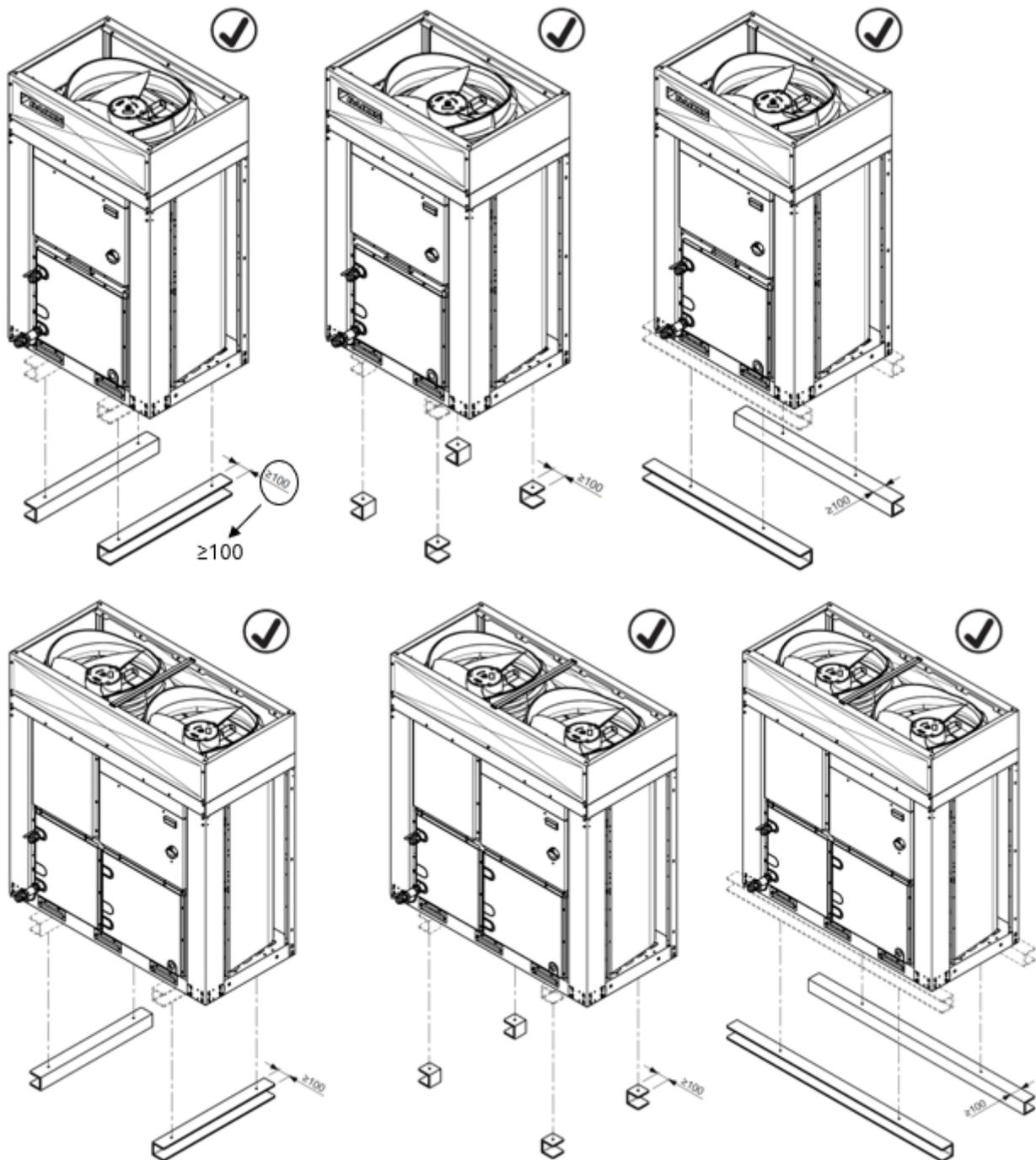
Abbildung 5 – Positionierung MONO-Gerät
