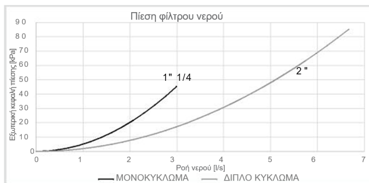
Εικόνα 13 - Πτώσεις πίεσης του φίλτρου νερού
