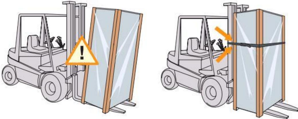
Für höhere Sicherheit beim Transport mit dem Gabelstapler wird empfohlen, die Tafel an das Hubgerüst anzulehnen und zu befestigen.
