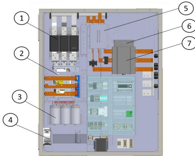
Abb.° 23 - Teile der Inverter-Schalttafel (Dual)
