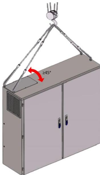
Bevor die Tafel mit einem Kran oder Brückenkran angehoben wird, ist zu prüfen, ob die folgenden Voraussetzungen erfüllt sind:
