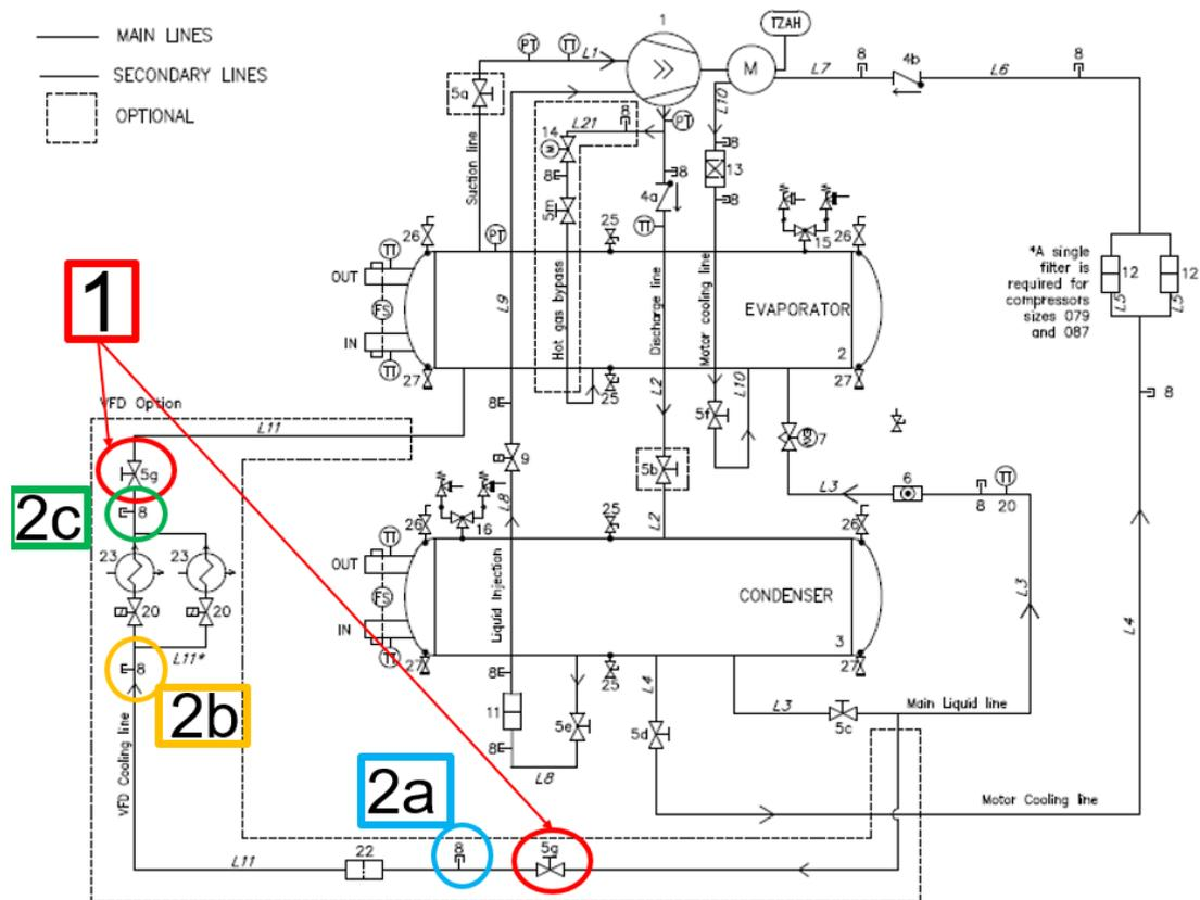
Abb.° 31 - P&ID-Schema der Einheit mit Detail der Inverter-Kühlleitung
