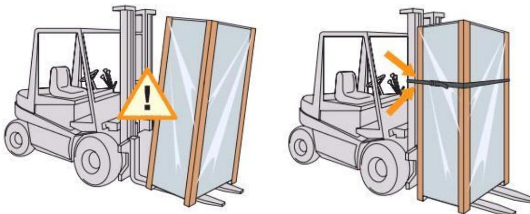
При транспортировке вилочным погрузчиком рекомендуется закрепить панель на вилочном погрузчике.
