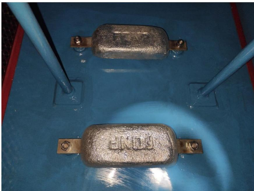
**ПРЕДУПРЕЖДЕНИЕ!** Чрезмерный расход анодов, выявленный при первом осмотре (через месяц), указывает на крайне агрессивную среду. Соответственно, измените план технического обслуживания в соответствии рабочими условиями. Рекомендуется заменять аноды, если их толщина менее 15 мм.
