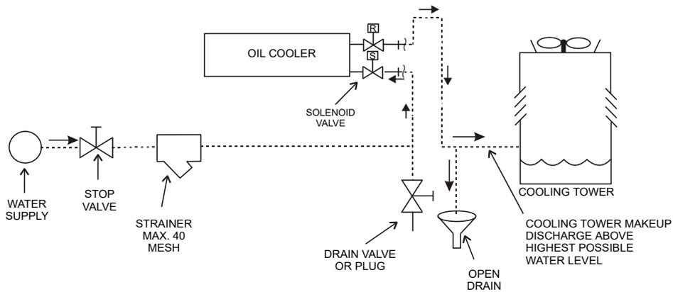
Рис. ° 11. DWSC, соединения контура масляного охлаждения
