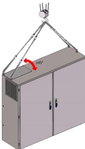
Перед подъемом панели с помощью обычного или мостового крана необходимо проверить следующие условия:
