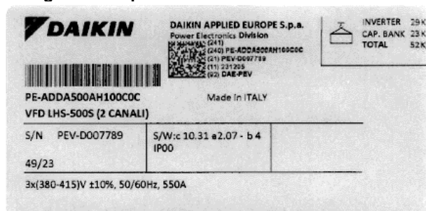
Fig.° 14 - Étiquette d'identification du VFD LHS
